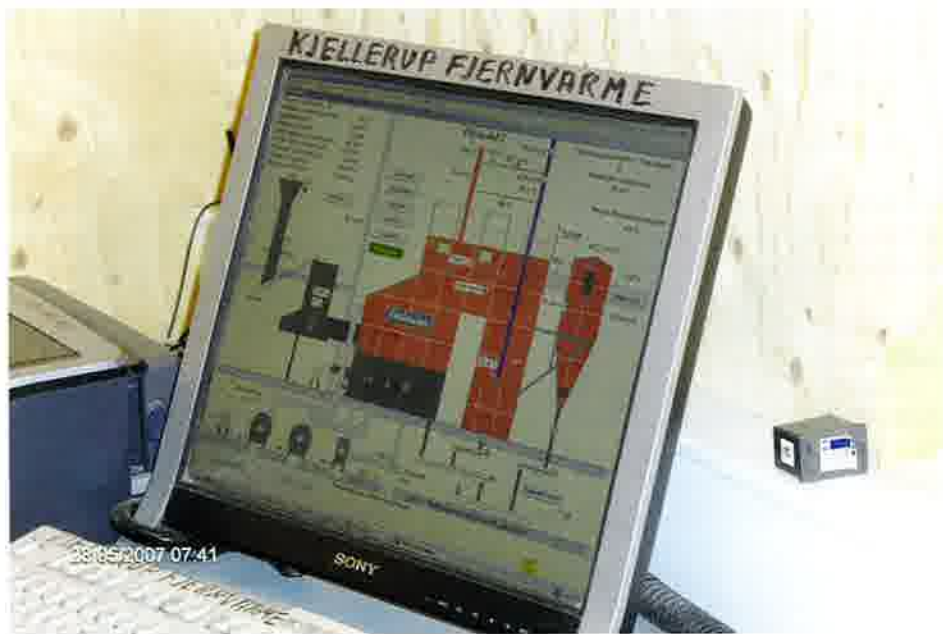
Skærbillede fra styringen til flisekedlerne på Agertofte
